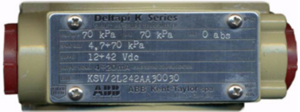
Figuur 198 Druktransmitter met een meetgebied of range van 0 - 70 kPa (a)
