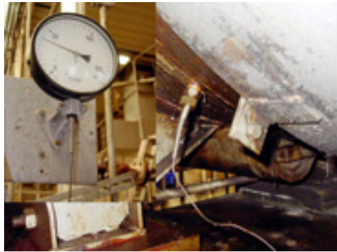
Figuur 387 Vloeistofgevulde thermometer
