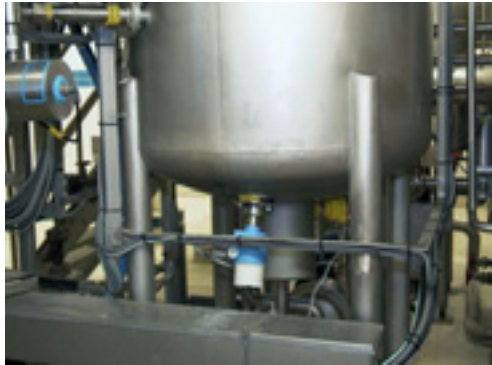
Figuur 280 Met druktransmitter met sanitaire procesaansluiting
