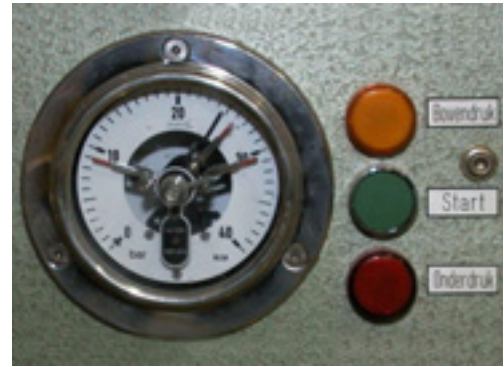
Figuur 614 Manometer met schakelcontacten
