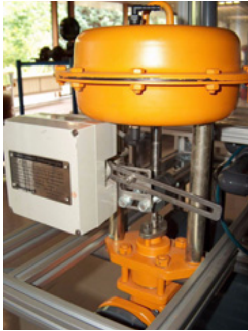
Figuur 507 Aansturing door middel van een klepstandsteller
