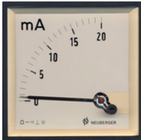
Figuur 68 Indicator met milli ampère meter
