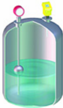
Figuur 262 Tank met niveautransmitter
