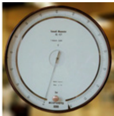
Figuur 206 Manometer met grote nauwkeurigheid (voor ijking)
