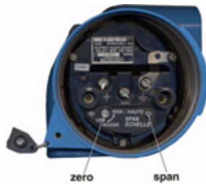
Figuur 201 Druktransmitter met span en zero instelpotmeters
